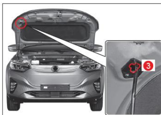
3. Insérez l'extrémité libre de la tige dans la fente(③)
